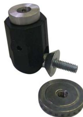
Une autre option consiste à utiliser le feutre *Wearaser* CS-5 et le collet *Wearaser* Jumbo. Divers produits chimiques peuvent ainsi être ajoutés. [Voir aussi Essai Crock.]
